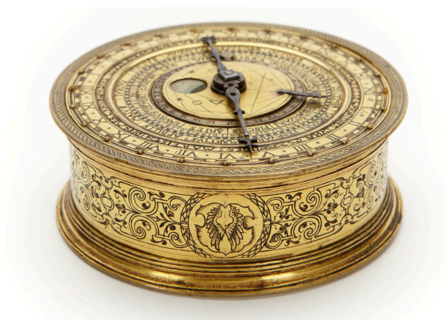
Kedjedrivett astronomiskt ur, visande månens faser, datum, solens ställning i zodiaken, månad, veckodag, timme och minut. Har tillhört Per Brahe den äldre. På botten undersida brahevapnet under friherrekrona samt inskrift: Petrus comes a Visingzbarg et baro a Ridboholm. I yttre ring: »WAKER FORTENSKVL TY I WETEN ECKE HVAD STVND EDER HERRE WARDER KOMENDES LUCE 24«. Föremålsnummer: 32_SKO. Fotograf: Erik Lernerstål 2013, Skoklosters slott/SHM (CC BY 4.0).
